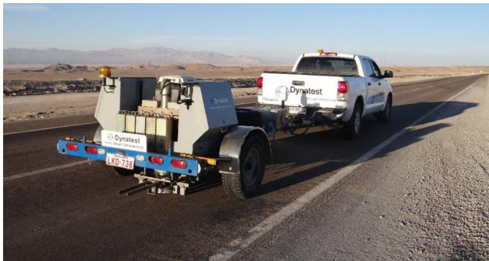
Figura 2. Deflectómetro Dynatest HWD 8081
